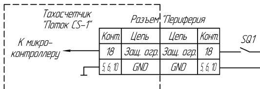
Рисунок А.7 - Схема подключения концевого выключателя защитного ограждения
