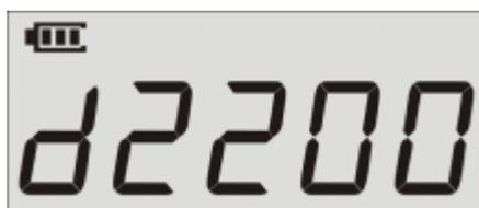
Рисунок 2.2. Выбор типа датчика давления.
