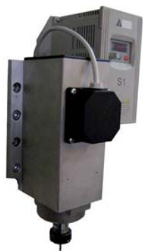
Усиленный мотор с инвертором
